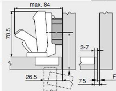
Retroceder la posición de fijación de la base en el espesor de la puerta +1.5 mm
